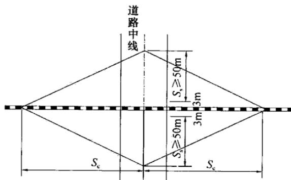
图 4 机动车驾驶员在道口前的瞭望视距示意图
