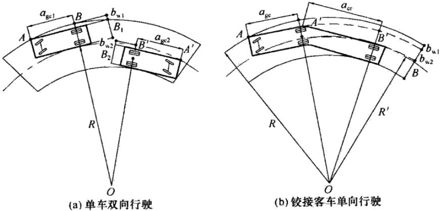
图1 圆曲线上路面加宽示意图
