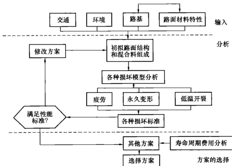
图 5 沥青路面设计流程
