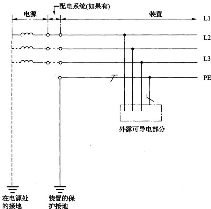
图 7.1.3-2 全部装置都具有接地的保护导体，
