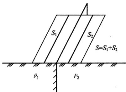
图 A. 0. 5-2 两种土壤电阻率的接地网
