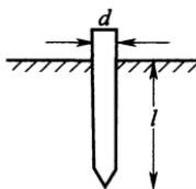
图 A.0.1-1 垂直接地极的示意
