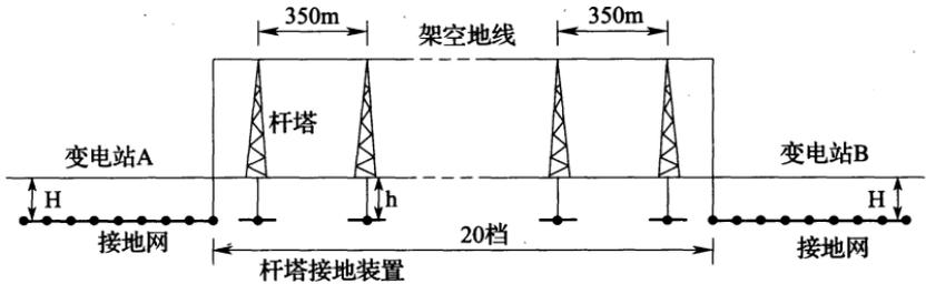
图 11 变电站 A 发生内部接地故障
