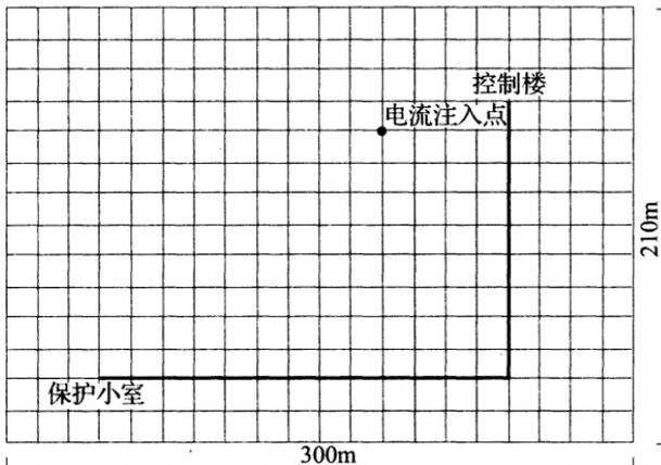
图6 电缆和电流入地点的位置示意
