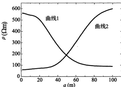
图 2 双层土壤的典型视在电阻率曲线
