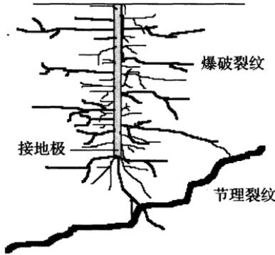
图 9 单根垂直接地极采用深孔爆破接地技术后形成的
