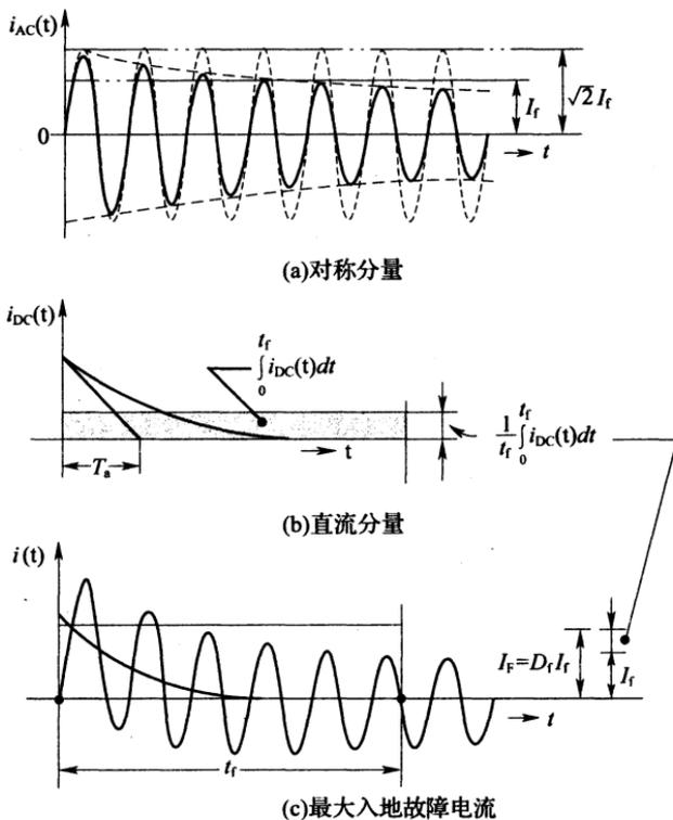
图 13 接地网最大入地故障电流(c)的
