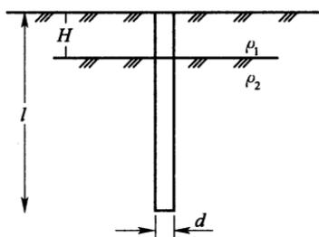
图 A. 0. 5-1 深埋接地体示意
