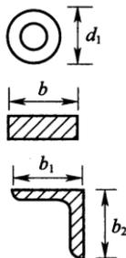
图 A.0.1-2 几种型式导体的计算用尺寸
