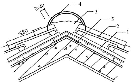
图 4.11.26 烧结瓦、混凝土瓦屋面屋脊
