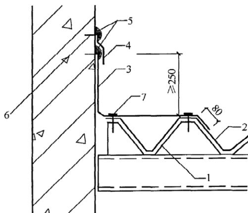
图 4.11.15-3 压型金属板屋面山墙
