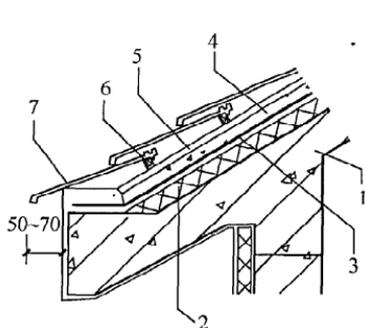
图 4.11.8-1 烧结瓦、混凝土瓦屋面檐口（一）
