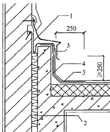
图 4.11.18-2 高低跨变形缝
