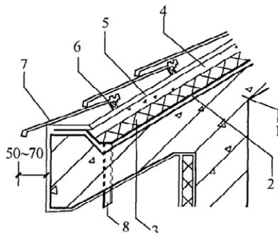
图 4.11.8-2 烧结瓦、混凝土瓦屋面檐口（二）
