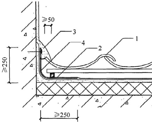
图 4.11.15-1 烧结瓦、混凝土瓦屋面山墙
