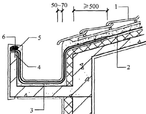
图 4.11.12 烧结瓦、混凝土瓦屋面檐沟
