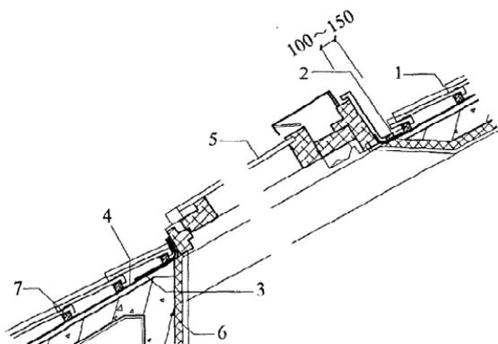
图 4.11.29 烧结瓦、混凝土瓦屋面屋顶窗
