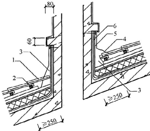
图 4.11.20 烧结瓦、混凝土瓦屋面烟囱
