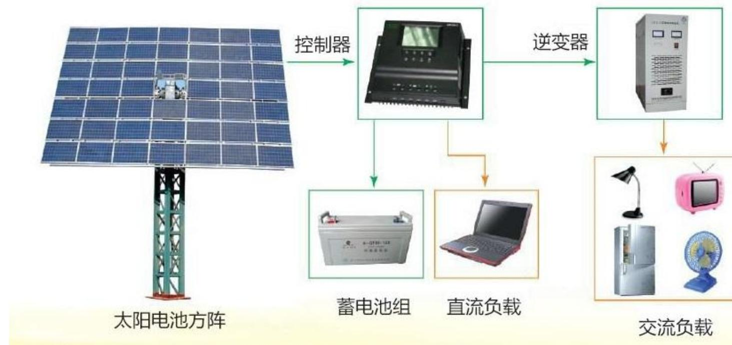
\*\*民用建筑（屋面）分布式光伏发电系统一般采用自发自用，余电上网的方式。
