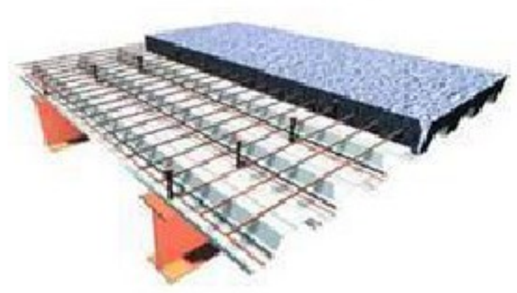
压型金属板工程
