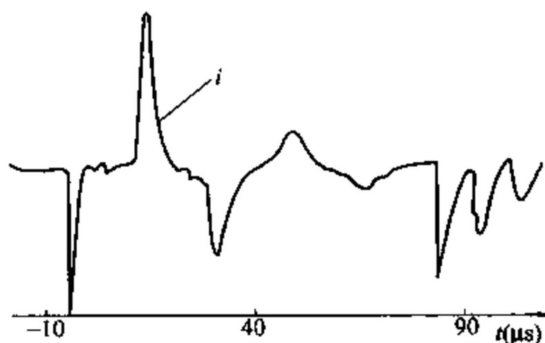
图 3-18 故障点起弧电流反射波波形图
