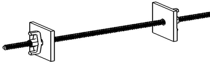
图B.8 对拉螺栓
