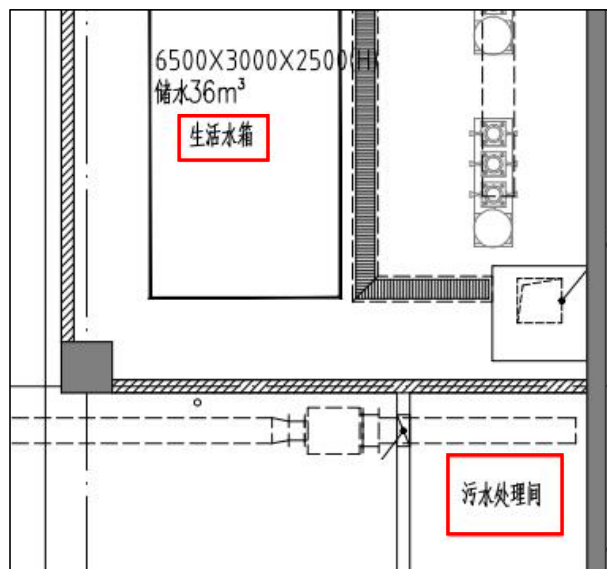
图 4-6 生活泵房毗邻污水处理间的问题示例
